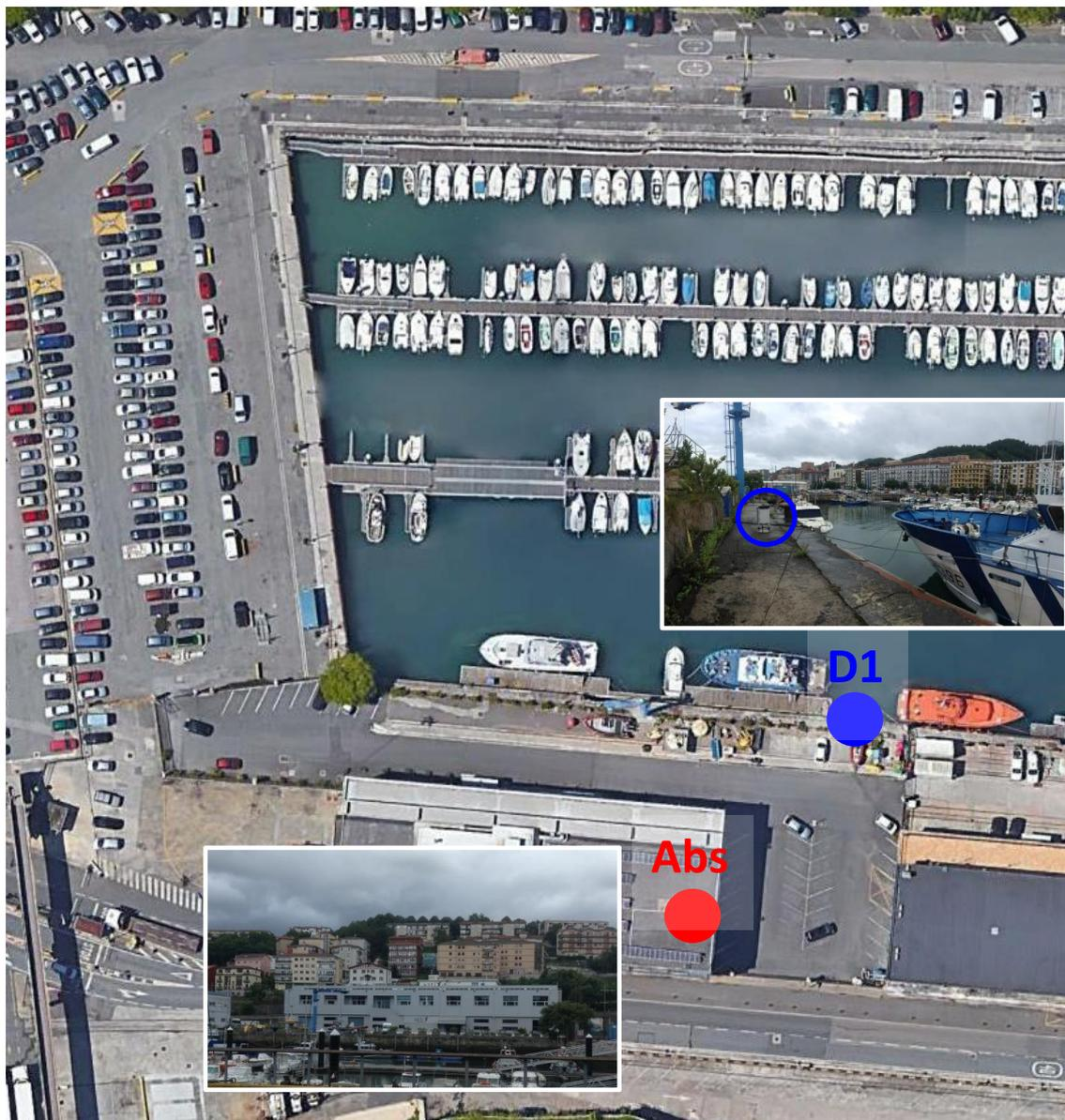
Figura 6. Imagen aérea del Puerto de Pasaia con las localizaciones de medida indicadas. En rojo la localización de la medida absoluta en el interior del laboratorio de la empresa AZTI cedido para la medida y en azul el del destacado realizado sobre la marca de referencia del mareógrafo.
