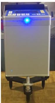
Se trata de un gravímetro relativo, capaz de medir diferencias de gravedad entre dos puntos dados con una precisión que puede alcanzar el  $1 \mu\text{Gal}$ , dependiendo de las condiciones ambientales. Su principio de funcionamiento consiste en la medida de variación de elongación que experimenta un muelle al ser sometido a una fuerza externa, que en este caso es la fuerza de la gravedad terrestre, la cual sufre variaciones tanto espaciales como temporales (Ver figura 2).
